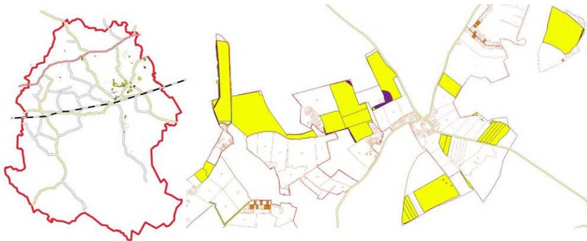
Рис. 4. Візуалізація геодезичного проєкту землекористування територіальної громади: ліворуч – загальна просторово-інформаційна структура, праворуч – фрагмент шарів «Особливо цінні продуктивні сільськогосподарські угіддя» та «Частини земельної ділянки» [10]
