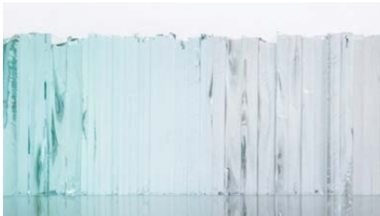
Рис. 9. Відмінність між звичайним склом (зліва) та просвітленим (справа)
