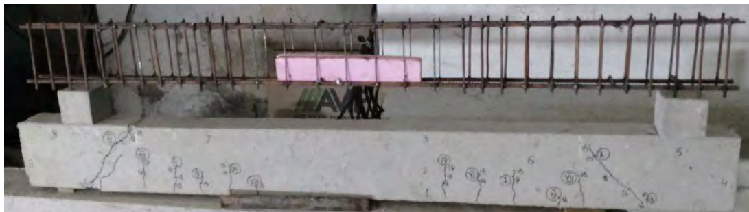
Рис. 3. Зразок балки, пошкодженої у розтягнутій зоні
