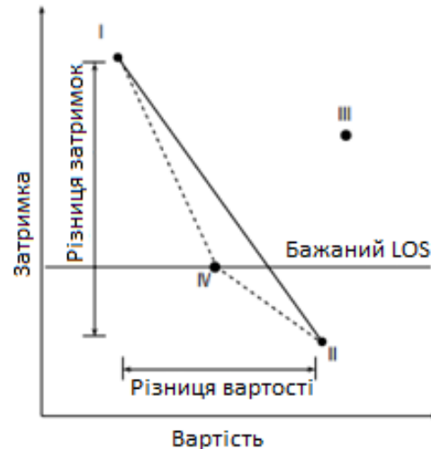
Рис. 2. Порівняльний графік залежності часу затримок від економічної вартості різних варіантів розв'язки. Горизонтальна вісь – вартість, вертикальна – затримки.
