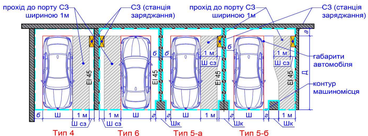
Рисунок 4. Типи машиномісць із СЗ в гаражах з розміщенням СЗ біля бокової сторони машиномісця
