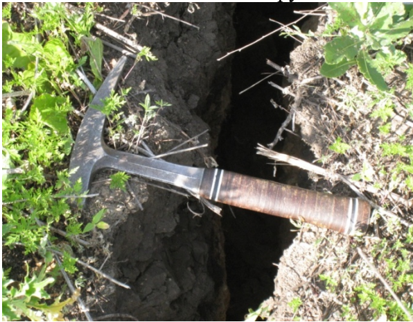
Рис. 14. Тріщини відриву в породах осадового чохла
