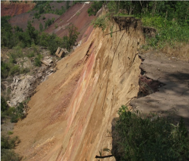
Рис. 13. Загальний вигляд обрушення земної поверхні в районі шахти ім. Орджонікідзе
